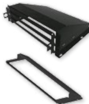
Дефлектор, направляющий холодный воздух из-под фальшпола в шкаф, может быть оснащен системой жалюзийных шторок, чтобы перекрыть приток воздуха, если в шкафу нет оборудования.
