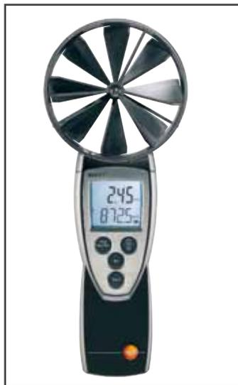
Anémomètre à moulinet avec le diamètre de 100 mm
