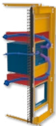
Příklad STS se dvěma kanály pro podporu proudění vzduchu
