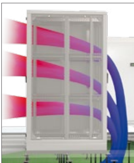
Studený vzduch je dodáván do studené uličky prostřednictvím dvojitě podlahy, která slouží jako provozní zásobník studeného vzduchu. Horký vzduch je vyfukován v zadní části do horké uličky.
