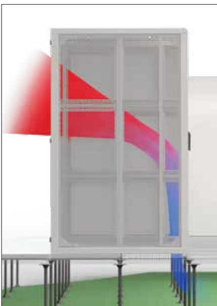
Kaltluft wird durch ein Leitblech in die Kaltzone gerichtet. Die Kaltzone besteht aus einem Luftseparationsrahmen, Blindplatten und einer nicht gelochten Vordertür. Warmluft entweicht aus dem Schrank durch eine superbelüftete Tür.
