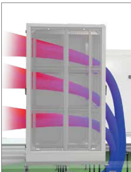
Die Kaltluft wird zum Kaltgang durch den Doppelboden als Kaltluftsammlerraum befördert. Die Warmluft wird auf der Hinterseite zum Warmgang ausgeblasen.
