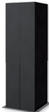
Die Kaminkonstruktion soll eine Warmabluftführung zwischen Schrank und Warmluft-Doppelboden formen. Ihre Höhe kann von 750 mm bis zu 1360 mm angepasst werden.
