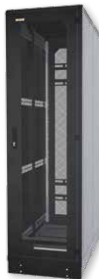
Die Schrankarchitektur in dem Warm-/Kaltgangkonzept erfordert belüftete Vordertür (86%) und belüftete Hintertür (86%) zum einfachen Zutritt zum Gang.
