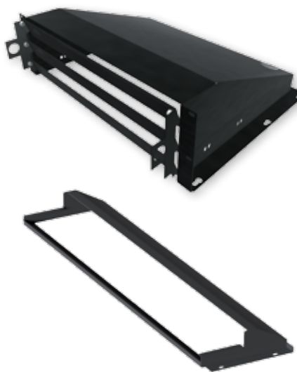
Ein Leitblech führt die Kaltluft (aus dem Doppelboden-Doppelboden) in den vorderen Schrankbereich. Zum Absperren der Luftleitung, wenn keine Geräte untergebracht werden, kann eine Luftstromregelklappe benutzt werden.
